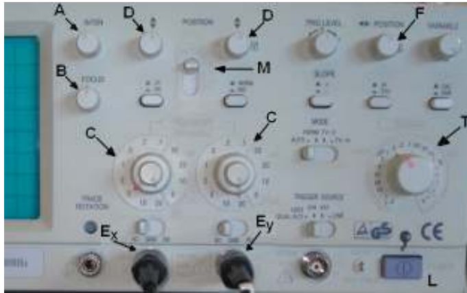
Figura 8.2- Parte do osciloscópio, exibindo seus principais controles
